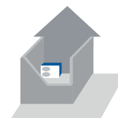
PAC placée dans une cour intérieure : +9 dB(A)
